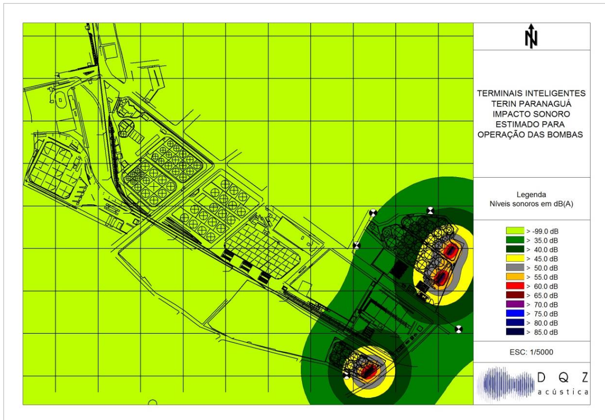
FIGURA 29 – MAPA DE RUÍDO DA REGIÃO DO LOTE - PROJEÇÃO DA OPERAÇÃO DAS BATERIAS DE BOMBAS ISOLADAMENTE (OPERAÇÃO ISOLADA)
