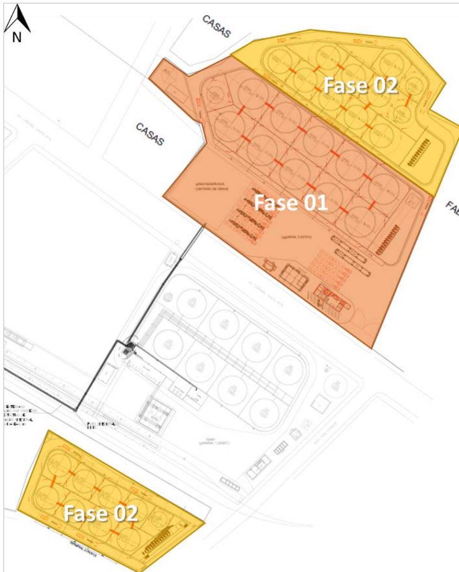
FIGURA 6 – DIVISÃO DAS ETAPAS DE CONSTRUÇÃO DO TERMINAL 2 E 3 FONTE: PROMON ENGENHARIA, 2018
