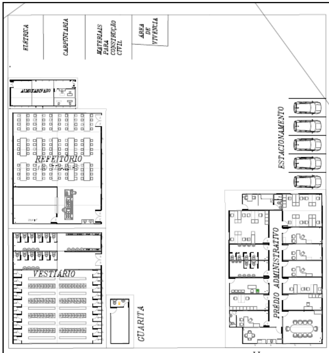
FIGURA 7 – REPRESENTAÇÃO DO LAYOUT DO CANTEIRO DE OBRAS FONTE: ADAPTADO DE ETRIN001-TU2-00001, 2020
